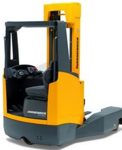
17. ábra Tolóoszlopos targonca - forrás: Jungheinrich.hu
