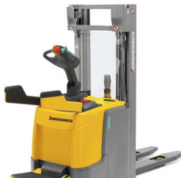
16. ábra Elektromos gyalogkíséretű targonca - forrás: Jungheinrich.hu
