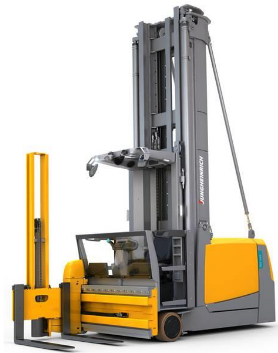
18. ábra Magasraktári targonca - forrás: Jungheinrich.hu
