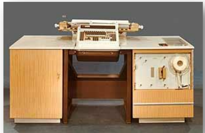
ASCOTA 170 könyvelőgép lyukszalaggal, a "könyvelőgépek királynője"
